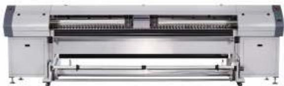
Широкоформатный УФ-принтер VISTA V30K для двусторонней печати в режиме «с рулона-на-рулон», с шириной печати до 3200мм и разрешением в 360dpi, обеспечивает высококачественную печать для наружного и интерьерного применения.
